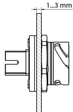
Wandstärke bei Verwendung der Zentralverschraubung
