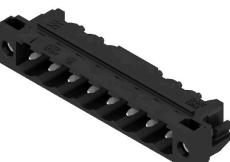
Hochtemperaturfeste Stifteleiste mit Verpackung in Box oder Tape. Im Tape mit 1,5 mm Lötstift optimiert für die Automatenbestückung. Lötstift 3,2 mm für Reflow- und Wellenlötanwendungen geeignet. Die Stifteleisten sind beschriftbar und können kodiert werden. HC = High Current.
