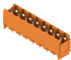
Stiftleisten aus glasfaserverstärktem Kunststoff mit gerader Abgangsrichtung optimiert für den Wellenlötprozess. Die Variante mit Flansch (F) lässt sich zur Verschraubung mit dem jeweiligen Gegenstück oder der Leiterplatte nutzen. Beim Einsatz der Lötfansch-Variante entfällt eine zusätzliche Verschraubung mit der Leiterplatte. Gleichzeitig werden die Lötstellen vor mechanischem Stress geschützt. Die Stiftleisten können manuell kodiert oder bereits vorkodiert bestellt werden.
