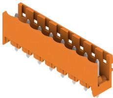
Stifteleisten aus glasfaserverstärktem Kunststoff mit gerader Abgangsrichtung optimiert für den Wellenlötprozess. Die Variante mit Flansch (F) lässt sich zur Verschraubung mit dem jeweiligen Gegenstück oder der Leiterplatte nutzen. Beim Einsatz der Lötfansch-Variante entfällt eine zusätzliche Verschraubung mit der Leiterplatte. Gleichzeitig werden die Lötstellen vor mechanischem Stress geschützt. Die Stifteleisten können manuell kodiert oder bereits vorkodiert bestellt werden. HC = High Current.
