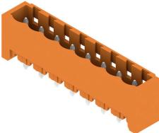
Stifteleisten aus glasfaserverstärktem Kunststoff mit gerader Abgangsrichtung optimiert für den Wellenlötprozess. Die Variante mit Flansch (F) lässt sich zur Verschraubung mit dem jeweiligen Gegenstück oder der Leiterplatte nutzen. Beim Einsatz der Lötfansch-Variante entfällt eine zusätzliche Verschraubung mit der Leiterplatte. Gleichzeitig werden die Lötstellen vor mechanischem Stress geschützt. Die Stifteleisten können manuell kodiert oder bereits vorkodiert bestellt werden.
