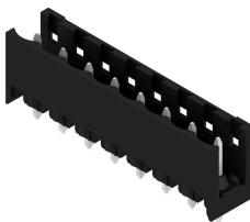
Hochtemperaturfeste, gerade, offene Stiftleiste. Verpackung in Box oder Tape. Im Tape und mit 1,5 mm Lötstift optimiert für die Automatenbestückung. Lötstift 3,2 mm für Reflow- und Wellenlötanwendungen geeignet. Die Stiftleisten sind beschriftbar und können kodiert werden. HC = High Current.
