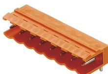
Stifteleisten mit 90° Abgangsrichtung. Die Lötstiftlänge ist für Wellenlötanwendungen optimiert. Die Stifteleisten bieten Platz für Beschriftungen und können kodiert werden.
