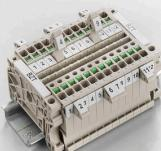
Die Bezeichnungsträger bieten die Möglichkeit der zusätzlichen Aufnahme von Standard Markierern im Raster von 5 bzw. 5.1 mm. Die gewinkelten Aufnahmen lassen sich wahlweise über miteinander verringen und lassen sich in allen Standard Markierungskanälen der Klippon® Connect Reihenklemmen montieren. Passende Markierer typen befinden sich unter dem jeweiligen Zubehör der Bezeichnungsträger.
