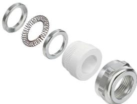
Die steigende Empfindlichkeit von elektronischen Bauteilen und die zunehmende elektromagnetische Strahlung erfordern das Kabelverschraubungen im Schirmungskonzept einer Anlage eine wichtige Rolle einnehmen. Diese Produktfamilie von EMV-Kabelverschraubungen dient zur Abschirmung gegen Störfrequenzen, sie verfügt über einen 360°-Schirmanschluss.
