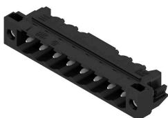
Hochtemperaturfeste Stifteiste mit Verpackung in Box oder Tape. Im Tape mit 1,5 mm Lötstift optimiert für die Automatenbestückung. Lötstift 3,2 mm für Reflow- und Wellenlötanwendungen geeignet. Die Stifteisten sind beschriftbar und können kodiert werden. HC = High Current.
