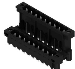
Hochtemperaturfeste, doppelstöckige, seitlich versetzte, Stifteleiste mit Flansch bzw. Lötfansch. Lötstift 1,5 mm für Reflowlötanwendungen geeignet. Lötstift 3,2 mm für Reflow- und Wellenlötanwendungen geeignet. Die Stifteleisten bieten Platz für Beschriftungen und können kodiert werden.
