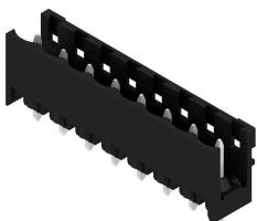
Hochtemperaturfeste, gerade, offene Stiftleiste. Verpackung in Box oder Tape. Im Tape und mit 1,5 mm Lötstift optimiert für die Automatenbestückung. Lötstift 3,2 mm für Reflow- und Wellenlötanwendungen geeignet. Die Stiftleisten sind beschriftbar und können kodiert werden. HC = High Current.
