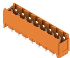
Stiftleisten aus glasfaserverstärktem Kunststoff mit gerader Abgangsrichtung optimiert für den Wellenlötprozess. Die Variante mit Flansch (F) lässt sich zur Verschraubung mit dem jeweiligen Gegenstück oder der Leiterplatte nutzen. Beim Einsatz der Lötplansch-Variante entfällt eine zusätzliche Verschraubung mit der Leiterplatte. Gleichzeitig werden die Lötstellen vor mechanischem Stress geschützt. Die Stiftleisten können manuell kodiert oder bereits vorkodiert bestellt werden.
