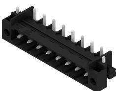
Hochtemperaturfeste, gerade, offene Stifteleiste. Verpackung in Box oder Tape. Im Tape und mit 1,5 mm Lötstift optimiert für die Automatenbestückung. Lötstift 3,2 mm für Reflow- und Wellenlötanwendungen geeignet. Die Stifteleisten sind beschriftbar und können kodiert werden. HC = High Current.
