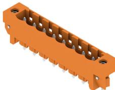
Stiftleisten aus glasfaserverstärktem Kunststoff mit gerader Abgangsrichtung optimiert für den Wellenlötprozess. Die Variante mit Flansch (F) lässt sich zur Verschraubung mit dem jeweiligen Gegenstück oder der Leiterplatte nutzen. Beim Einsatz der Lötfansch-Variante entfällt eine zusätzliche Verschraubung mit der Leiterplatte. Gleichzeitig werden die Lötstellen vor mechanischem Stress geschützt. Die Stiftleisten können manuell kodiert oder bereits vorkodiert bestellt werden. HC = High Current.
