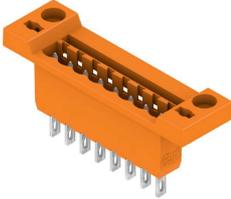
Durchführungsstiftleiste zur Frontplattenmontage mit optionaler Verriegelungsfunktion. Der interne Anschluss erfolgt als Flachsteck- oder Lötanschluss. Die Stiftleisten sind beschriftbar und können kodiert werden.
