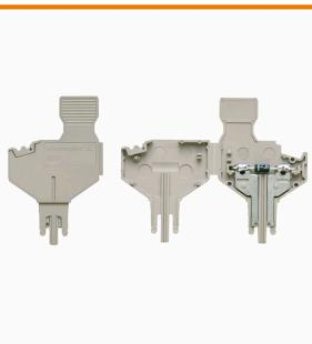
Der Bauelementestecker dient dem integrieren einer elektrischen Komponente in einer Trennreihenklemme. Nach dem Einlöten der jeweiligen Komponente lässt sich der Stecker in den Trennbereich unserer Reihenklemmen integrieren und ändert dadurch die Trennklemme zu einer Reihenklemme mit integrierter elektronischen Komponente.
