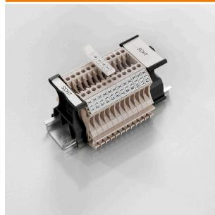
Der Gruppenschildträger SchT 5 S wird direkt auf die Tragschiene TS 32 (G-Schiene) bzw. die Tragschiene TS 35 (Hutschiene) aufgerastet. Unabhängig von Klemme und Klemmentyp kann so die Klemmleistenkennzeichnung vorgenommen werden. SchT 5 und SchT 5 S werden mit ESO 5, STR 5 Schutzstreifen bestückt.
