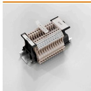
SCHT 5 S 成组记座可以直接卡在 TS32 安装导轨 (G 型轨) 或 TS35 安装导轨 (U 型轨) 上。您无需考虑接线端子型号, 即可对端子条进行成组标记。
