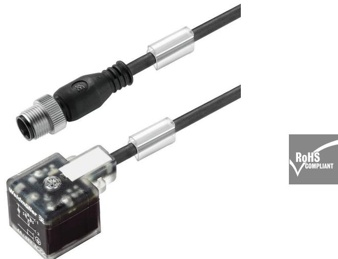
魏德米勒可以提供阀塞作为连接线，其中带有 M8/M12 插头，且单侧开放。阀塞的状态用一个 LED 显示。每个阀塞都有一个保护电路。魏德米勒系列包括符合 DIN 和工业标准的 A、B 和 C 型阀塞。阀塞拧紧后可达到 IP 67 防护等级。出口方向也是一个决定性因素，因此魏德米勒提供不同出口方向的版本。
