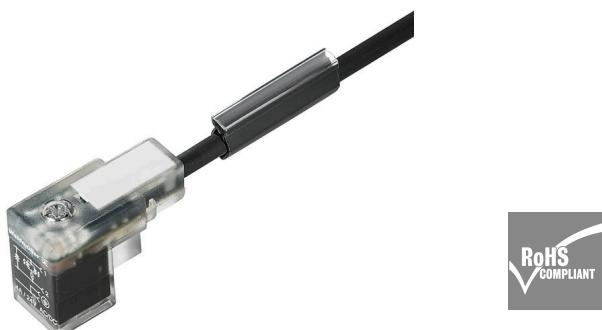
魏德米勒可以提供阀塞作为连接线，其中带有 M8/M12 插头，且单侧开放。阀塞的状态用一个 LED 显示。每个阀塞都有一个保护电路。魏德米勒系列包括符合 DIN 和工业标准的 A、B 和 C 型阀塞。阀塞拧紧后可达到 IP 67 防护等级。出口方向也是一个决定性因素，因此魏德米勒提供不同出口方向的版本。
