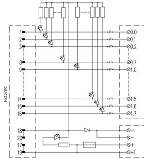
接线图适用于带 LED 的规格。
