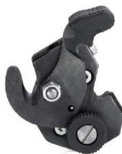
Swift® CS 和 Swift® CS set 集成断线剥线功能，用于切割和剥离铜导线，适用于最大 1.5 mm<sup>2</sup> 的单股硬导线和 2.5 mm<sup>2</sup> 的多股软导线。
