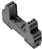
拔插式VSPC 电涌保护底座。中性阻抗VSPC底座中有集成PE接地脚和 浮动接地PE连接 (FG) 通过内置 火花间隙, 安全放电达20kA (8/20μs), 对PE安全放电为2.5kA (10/350μs)。 适合用于未接地的信号电路。
