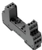
拔插式VSPC 电涌保护底座。中性阻抗VSPC底座中有集成PE接地脚和 浮动接地PE连接 (FG) 通过内置 火花间隙, 安全放电达20kA (8/20μs), 对PE安全放电为2.5kA (10/350μs)。 适用于未接地的信号电路。
