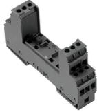
可插拔式电涌保护器 VSPC 的底座，内置接地点。可以安全释放 20 kA (8/20 μs) 和 2.5 kA (10/350 μs) 的电流。
