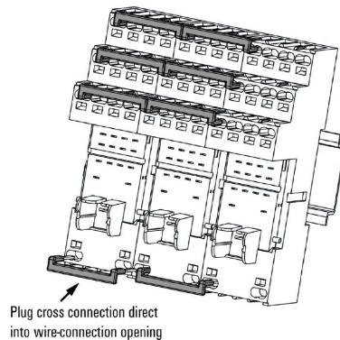
将横联联接插入至电缆接线处
