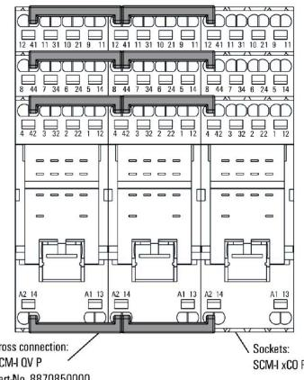
横联件桥接至相邻底座上相同的接线点
