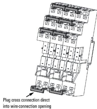
将横联联接插入至电缆接线处
