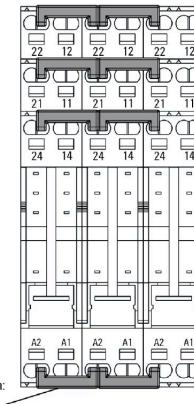
横联件桥接至相邻底座上相同的接线点
