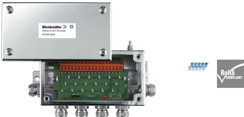
对于标准工业应用（非危险区域），PROFIBUS PA 接线箱和限制器可提供 1 向、2 向、4 向、8 向分线盒系列产品。FBCon 限制器的设计是为了保护连接的现场设备免受过电压和短路的影响。作为电压限制保护元件，使用抑制二极管。由于集成电流限制，该段还可防止支线上的短路。EMC 电缆接头，IP66 防护等级和广泛的工作温度范围可在恶劣环境中安全保护您的联接。
