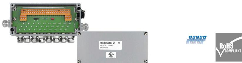
对于标准工业应用（非危险区域），PROFIBUS PA 接线箱和限制器可提供 1 向、2 向、4 向、8 向分线盒系列产品。FBCon 限制器的设计是为了保护连接的现场设备免受过电压和短路的影响。作为电压限制保护元件，使用抑制二极管。由于集成电流限制，该段还可防止支线上的短路。EMC 电缆接头，IP66 防护等级和广泛的工作温度范围可在恶劣环境中安全保护您的联接。
