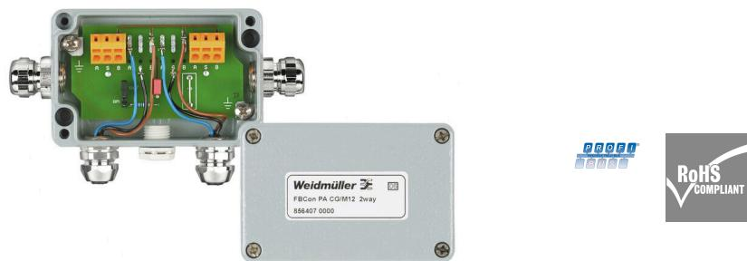
对于标准工业应用（非危险区域），PROFIBUS PA 接线箱和限制器可提供 1 向、2 向、4 向、8 向分线盒系列产品。FBCon 限制器的设计是为了保护连接的现场设备免受过电压和短路的影响。作为电压限制保护元件，使用抑制二极管。由于集成电流限制，该段还可防止支线上的短路。EMC 电缆接头，IP66 防护等级和广泛的工作温度范围可在恶劣环境中安全保护您的联接。
