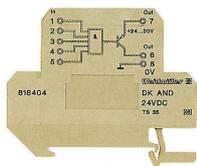
接线范围为 4 mm<sup>2</sup> 的端子模块具有 AND、NAND、OR 和 NOR 逻辑功能。每个端子模块都配有 5 个输入端, 通过 24 V/ 20 mA PNP 输出端实现逻辑连接。逻辑模块被广泛用于耦合自动化设备的数字传感器/执行器信号。
