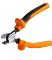
用于外径最大 8 mm、12 mm、14 mm 和 22 mm 的导线的切割工具。特殊的刀片几何形状允许以最小体力对铜和铝导线进行无挤压切割。根据 EN/IEC 60900 标准，切割工具 (KT 8 至 KT 22) 还配备通过 VDE 和 GS 测试的保护绝缘层，电压最高可达 1,000 V。
