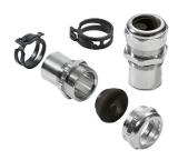
随着电子组件的灵敏度不断提高,电磁干扰频率不断提高,电缆接头需要在系统的屏蔽概念中发挥重要作用。这类EMC电缆接头采用360°筛查接线点,可屏蔽干扰频率。手指锁定密封件可提供出色的电缆保持和张力释放效果,其旁边的电缆接头符合EN 62444的机械要求。专利设计让组装变得轻松快捷。
