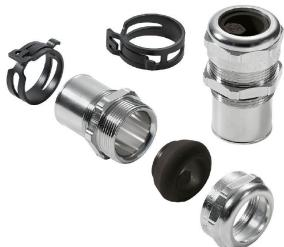
随着电子组件的灵敏度不断提高，电磁干扰频率不断提高，电缆接头需要在系统的屏蔽概念中发挥重要作用。这类EMC电缆接头采用360°筛查接线点，可屏蔽干扰频率。手指锁定密封件可提供出色的电缆保持和张力释放效果，其旁边的电缆接头符合EN 62444的机械要求。专利设计让组装变得轻松快捷。
