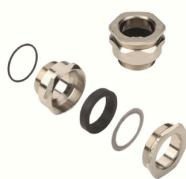
KSG 专门用于联接非铠装电缆和导线。如果订购的电缆接头带氯丁橡胶密封圈，则适用的温度范围为 -35°C - +90°C。选用硅胶密封圈时，适用的温度范围为 -60°C 到 +180°C。附件电缆接头 O型圈采用相同材料。在 25米水深下（2.5 巴），密封圈材料可达到 IP 66 或 IP 68 防护等级。KSG 可以与 Ex d 防火罩一起使用，提高防爆安全。
