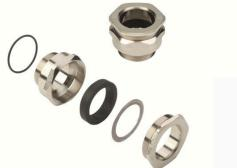
KSG 专门用于联接非铠装电缆和导线。如果订购的电缆接头带氯丁橡胶密封圈，则适用的温度范围为 -35°C - +90°C。选用硅胶密封圈时，适用的温度范围为 -60°C 到 +180°C。附件电缆接头 O型圈采用相同材料。在 25米水深下（2.5 巴），密封圈材料可达到 IP 66 或 IP 68 防护等级。KSG 可以与 Ex d 防火罩一起使用，提高防爆安全。
