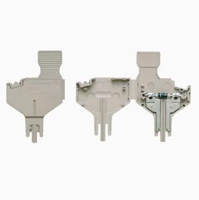
插头组件用于将电气组件安装在可拆式接线端子。电子组件完成焊接之后，可以将插头安装到可拆式接线端子的断开区域，从而将可拆式接线端子变成配有内置电子组件的模块化接线端子。
