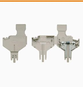
插头组件用于将电气组件安装在可拆式接线端子。电子组件完成焊接之后，可以将插头安装到可拆式接线端子的断开区域，从而将可拆式接线端子变成配有内置电子组件的模块化接线端子。
