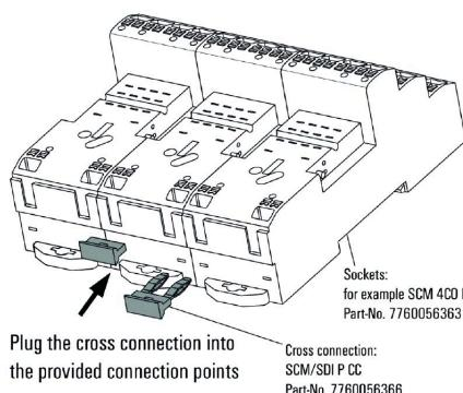
怎样安装横联件至 SCM 的横联 A2触点上... PUSH IN 插座
