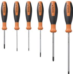
魏德米勒通用型高质软手柄螺丝刀的刀刃由高合金铬钒钼钢制成，经过完全硬化并镀铬。
