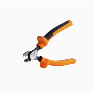
用于外径最大 8 mm、12 mm、14 mm 和 22 mm 的导线的切割工具。特殊的刀片几何形状允许以最小体力对铜和铝导线进行无挤压切割。根据 EN/IEC 60900 标准, 切割工具 (KT 8 至 KT 22) 还配备通过 VDE 和 GS 测试的保护绝缘层, 电压最高可达 1,000 V。
