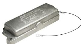
可选择符合以下认证标准的 2 区电缆分离选项 : ATEX: T II 3G Ex ec IIC T6 Gc 或 IECEX: Ex ec IIC T6 Gc, 简化了安装维护流程, 有助于更好地完成前期准备工作。所提供的认证接连接器必须始终与配套的认证外壳及插芯组件成套使用, 并且只能在无负载的情况下断开连接。
