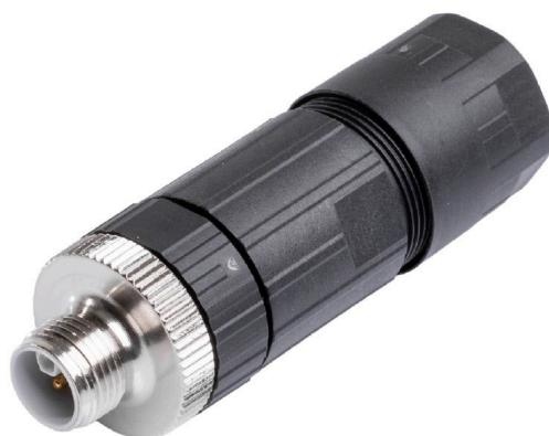
您的外围设备应配备更大的电源。借助我们新的 M12 接插件，超过 250 V 和 2 A 的电压不会出现任何问题。紧凑型 A-、K-、L-、S- 和 T-编码 M12 接插件用于传输最高 630 V 交流电或 60 V 直流电的电压以及 12 A 的电流。
