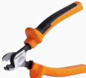
用于外径最大 8 mm、12 mm、14 mm 和 22 mm 的导线的切割工具。特殊的刀片几何形状允许以最小体力对铜和铝导线进行无挤压切割。根据 EN/IEC 60900 标准，切割工具 (KT 8 至 KT 22) 还配备通过 VDE 和 GS 测试的保护绝缘层，电压最高可达 1,000 V。
