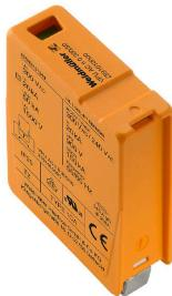
魏德米勒 VPU I (I级)、VPU II (II级)和VPU III (III级) 电涌保护器产品能够有效减少瞬时放电引起的干扰耦合, 使之大大低于 EN 60664-3 / DIN VDE 0110-3 标准的要求值。这也减少了装置的故障率。通过技术手段实现电涌保护器的协调作用。因此 I 级、II 级和 III 级装置之间无需断开。放电管符合 IEC 61643-11 / DIN EN 61643-11 产品标准, 且根据 IEC 61643-12 / VDE 0675-6-12 标准和 IEC 62305-4 / VDE 0185-4 标准可以用于系统内。本避雷/电涌保护装置适用于电源系统。魏德米勒将根据具体供电网络的类型和电压水平提供不同的产品。VPU AC II F 系列的特点是在避雷器中集成了保险丝。这些避雷器不需要保险丝。
