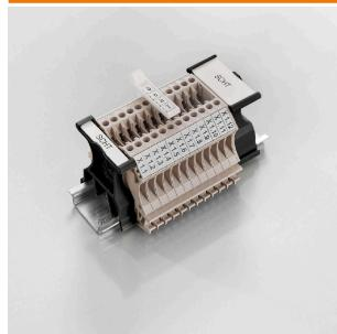
SCHT 5 S 成组记座可以直接卡在 TS32 安装导轨 (G 型轨) 或 TS35 安装导轨 (U 型轨) 上。您无需考虑接线端子型号，即可对端子条进行成组标记。SchT 5 和 SchT 5 S 装配有 ESO 5、STR 5 防护条。SchT 7 是折页式成组标记座，可以装插入式标签，对于压线框端子而言，使用非常容易。SchT 7 装配有 ESO 7、STR 7 防护条或 DEK 5。有关插入式标签和防护条请参见“附件”。
