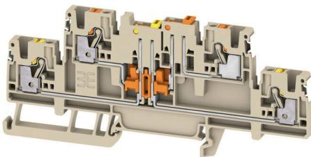
在某些应用中，我们会需要出于测试和安全目的向直通型接线端子添加一个测试点或开关元件。使用开关型端子，您可在无电压的情况下对电路进行测量。由于开关点的电气间隙和爬电距离无法评估尺寸，我们必须对指定的额定脉冲电压强度进行论证。
