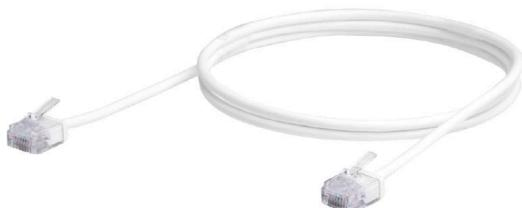
预装配电缆，配有 2 个 RJ45 接口，防护等级为 IP20，适用于智能计量应用，6 类 Microline - 超细线 (AWG30)，非屏蔽，适用于狭小空间，可按要求提供其他颜色
