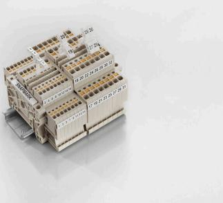
SnapMark —— 这种标记座最早是专门为 I 系列的 IDK 1.5 N 的双层端子构思而研发的。灵活的可旋转的结构可以毫不费力地装配和拆卸横联件。这种标记座可以适合装四个 DEK 5 标记号和两个 WS 10/5 (中间脚) 的标记号。
