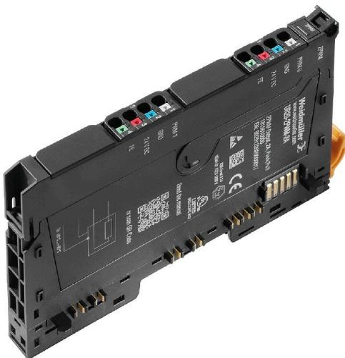
脉冲宽度调制模块和步进电机模块作为 u-remote 系统的一部分，魏德米勒为电流要求为 0.5 A 至 2 A 的小型电机的控制提供了专门解决方案，还可以用于控制阀门的蝶形件。脉冲宽度调制模块可在高达 40 kHz 的开关频率范围内进行调整，在电机控制中，也可以借助推/拉输出级来切换模块，例如改变旋转方向。魏德米勒步进电机模块灵活高效，适用于机器人、搬运系统或带有步进电机的放置机的自动化。可变可调的运行参数和 12 V 至 50 V 的宽泛直流电源范围使模块非常灵活，适用于各种目标应用。六个集成的且可参数化的编码器或数字输入端以及两个 0.5 A 的数字输出端使控制模块成为狭窄空间内的完整解决方案。与 u-remote 系统的所有模块一样，此类模块也具有非常突出的特点，包括模块设计、可互换电子元件以及可拆卸直插式端子条。模块的电子元件为所连接的执行器供电，供电通过输出电流路径 (UOUT)
