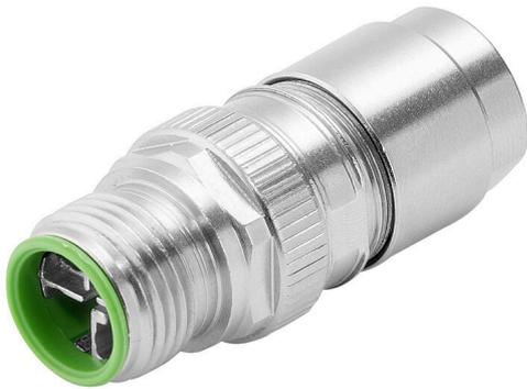
带 X 编码和 90° 电缆出口的 8 极 M12 Mini 压接电缆连接器，具有紧凑型尺寸和 8 个电缆出口位置，专为严苛的安装条件而设计。电缆夹接版本的电缆夹接范围为 4 mm 到 9 mm，加上全屏蔽外壳和屏蔽式应力消除装置，是市场上所有常见电缆的通用故障安全型解决方案。
