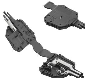
加上 SIHA 熔芯架后, 普通的端子立即变成了熔断型端子, 只需移走绝缘盖子, 插上熔芯插头。
