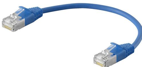
已预装带 2 个 RJ45 接头的电缆，适用于智能计量应用，采用符合 DIN VDE 0603-100 标准的颜色编码。用于狭小空间的短插头和小弯曲半径电缆，插头外壳全周绝缘，在连接状态下能实现 IP30 防护等级。
